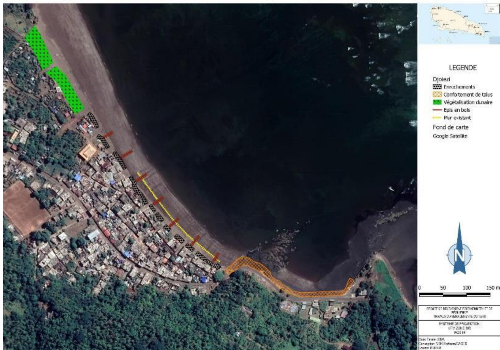
Figure 1: Schématisation des parades de protection côtière proposées pour le site de Djoiezi
