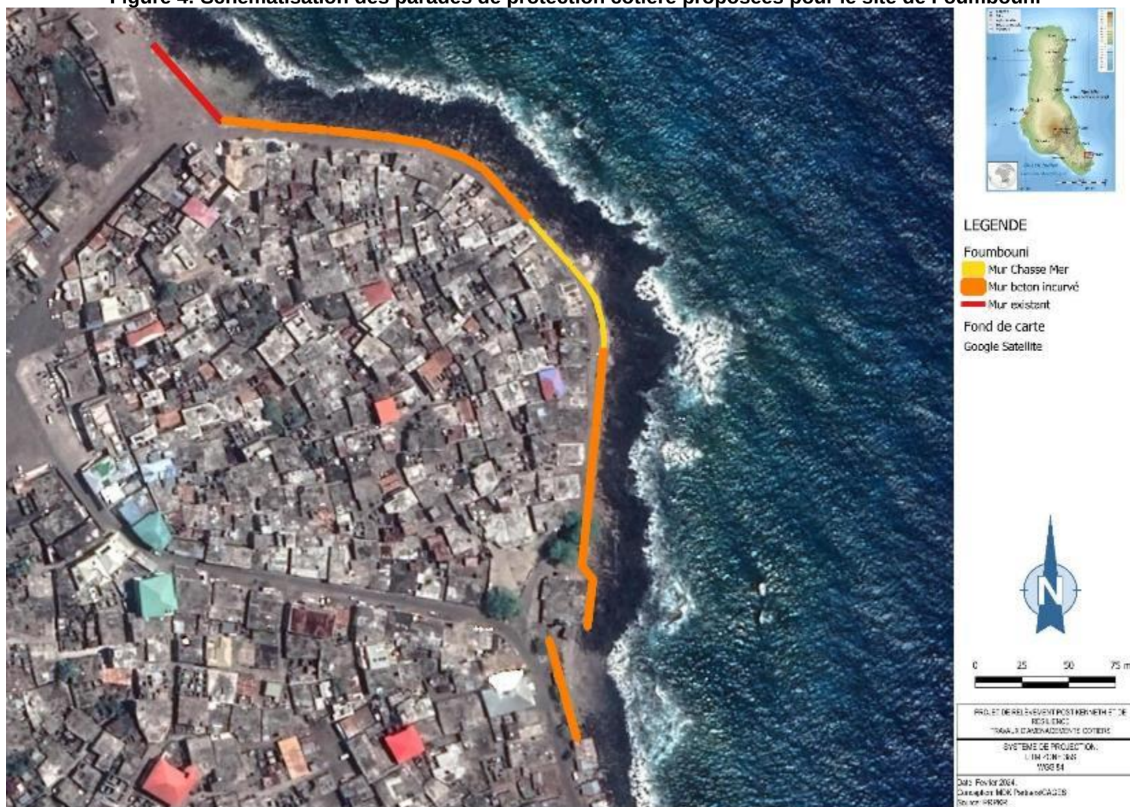
Figure 4: Schématisation des parades de protection côtière proposées pour le site de Foubouni
