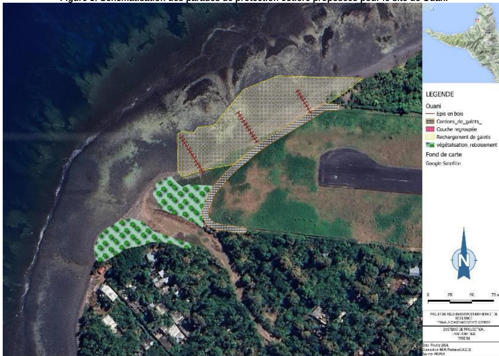
Figure 3: Schématisation des parades de protection côtière proposées pour le site de Ouani
