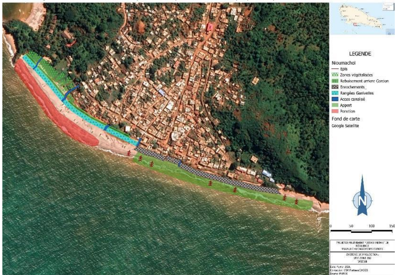
Figure 2 : Schématisation des parades de protection côtière proposées pour le site de Nioumachoi
