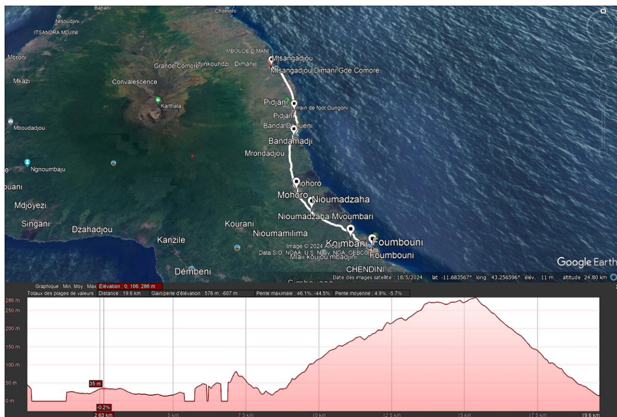
Figure 1 : Profil de dénivelé de la RN3 (section Mtsangadjou- Founbouni)
